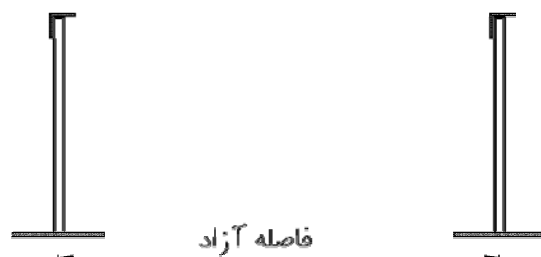
شکل ۸-۲- فاصله‌ی آزاد بین تیرچه‌های فولادی
